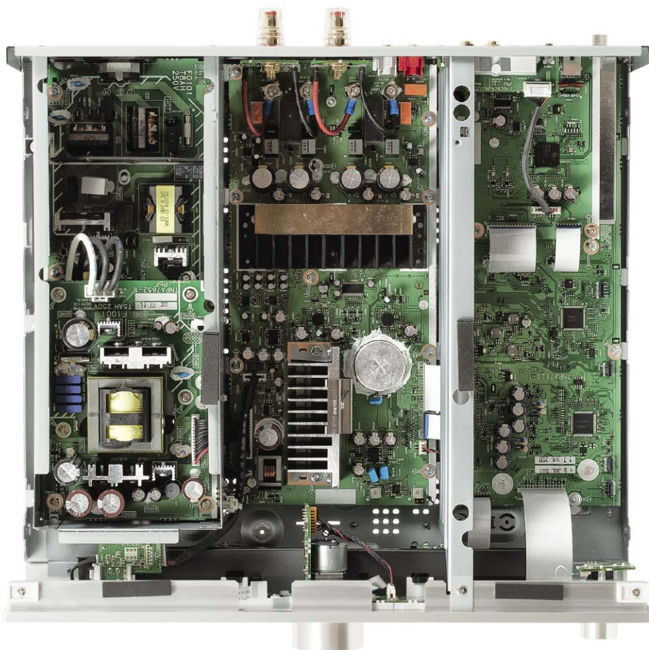
Wnętrze zaaranżowano w trzech głównych komorach – dla przedwzmacniacza, końcówek mocy oraz zasilacza
